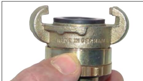
Vorgeschaubte Dichtung - Verbindung ist dicht.
